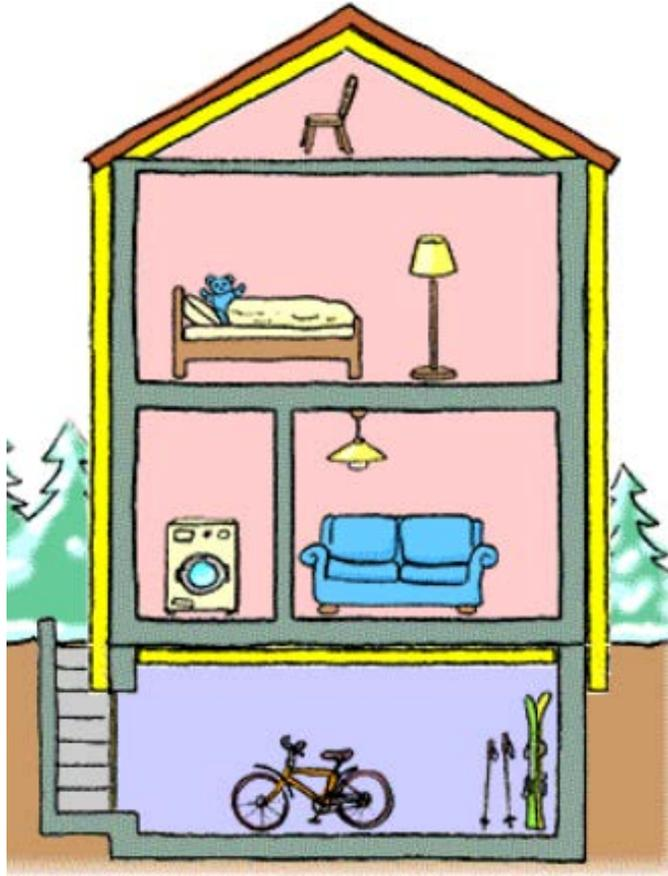
In Bezug auf die Energieersparnis ist dies die beste Lösung, denn das Gebäude ist ganz und gar in die Isolationsschicht eingepackt (16-22 cm).
