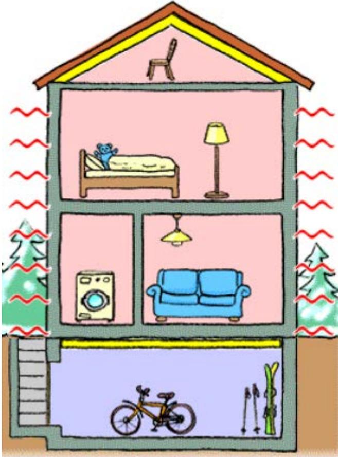
Mit ein bisschen Heimwerkererfahrung ist diese Arbeit leicht auszuführen. Isolationsplatten für die Decke können aufgeklebt, angeschraubt oder auf Holzlatten fixiert werden.
