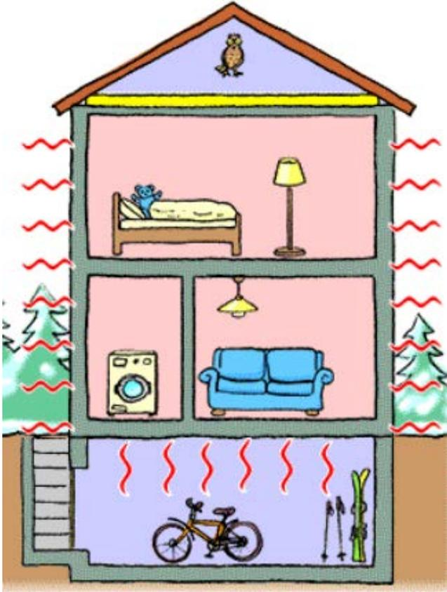
Wird der Boden mit einer dicken Isolationsschicht (18-24 cm) abgedichtet, können Wärmeverluste nach oben stark begrenzt werden.
